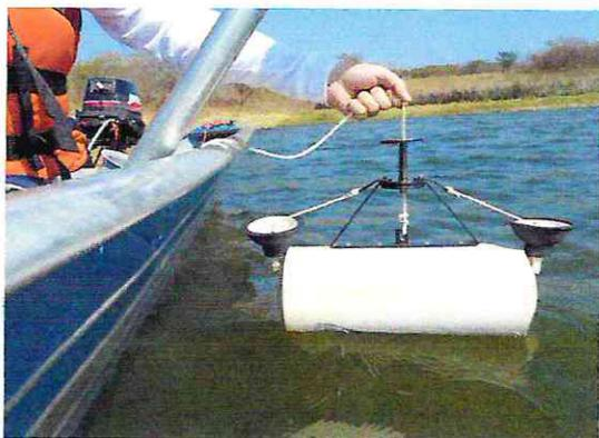
**Figura 8** – Coleta de água no açude Quieto, utilizando garrafa de van Dorn
