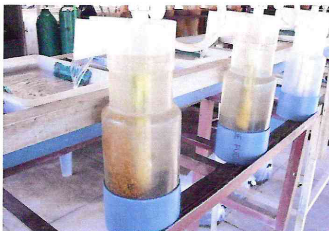
Figura 20 - Incubadora dos ovos e bandeja plástica para coleta das pós-larvas, no Centro de Pesquisas em Aquicultura Rodolpho von Ihering – CPAq - DNOCS, Pentecoste - Ceará, 2011.
