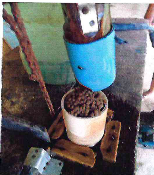
Figura 11 – Prensa manual para compactação dos agregados preparados com ração extrusada e pasta de tilápia, utilizados na alimentação dos juvenis de pirarucu Arapaima gigas , no Centro de Pesquisa em Aquicultura Rodolpho von Ihering (CPAq/DNOCS), Pentecoste – CE.
