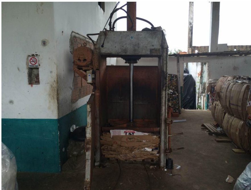
Figura 16 - Máquina utilizada para prensar o lixo de cada material (na foto, a máquina aberta com papelão prensado).
