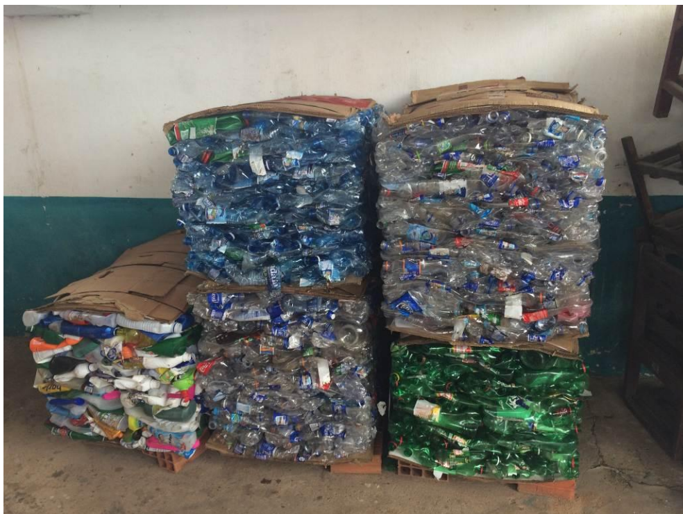
Figura 18 - Material de plástico após passar pela prensa, pronto para a comercialização.
