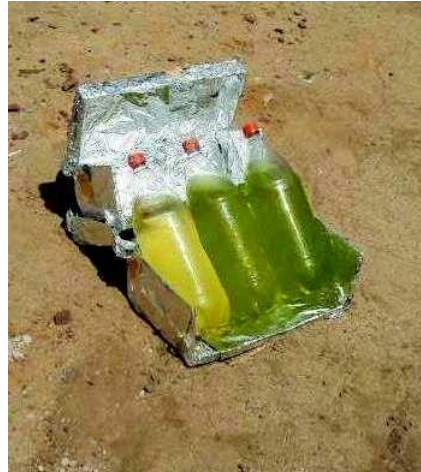
Figura 23: Exposição da água clarificada ao sol
