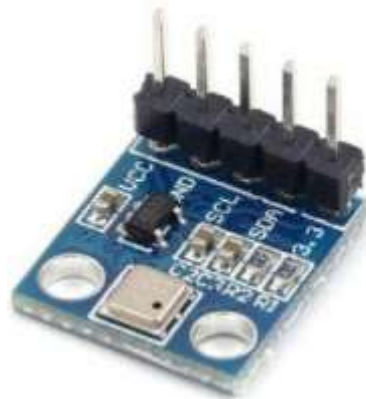
Figura 15 - Sensor barométrico BMP 180
