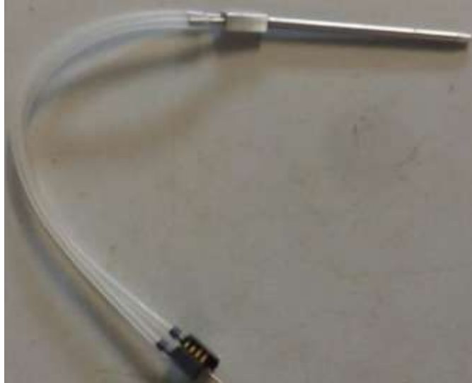
Figura 18 - Sensor Mpxv7002dp com tubo de pitot
