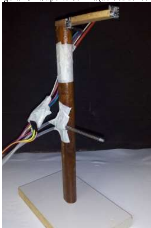
Figura 25 - Suporte de fixação dos sensores
