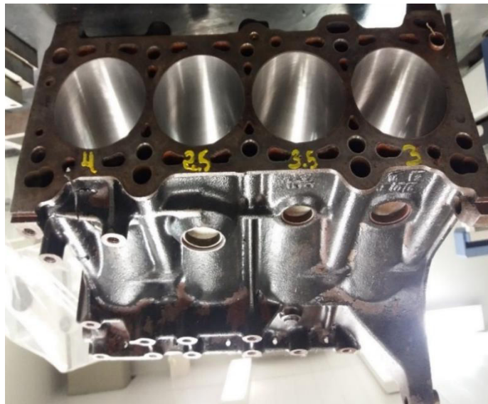
Figura 39 – Motor estudado após o processo de brunimento
