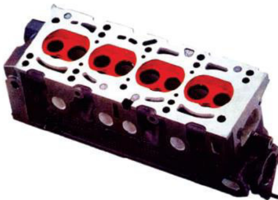
Figura 8 – Cabeçote de um motor de 4 cilindros
