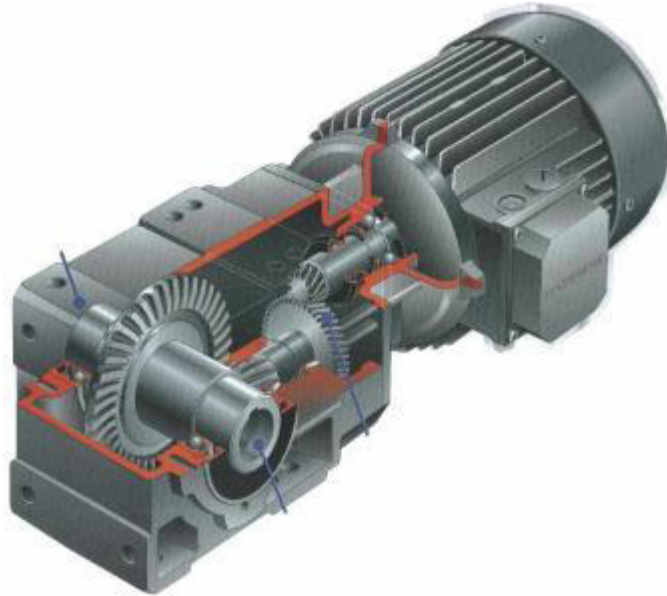
Figura 27 - Estrutura de uma caixa de redução. Fonte: Claudinei Bigaton, IFCE
