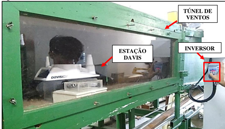
Figura 17 – Ensaio no túnel de ventos: anemômetro Davis
