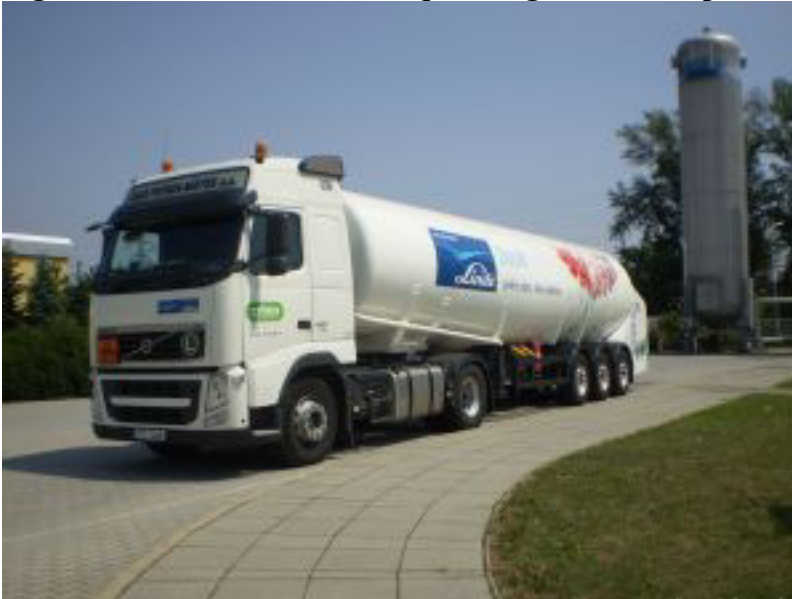
Figura 12- Caminhão com tanque criogênico da empresa Linde Gases
