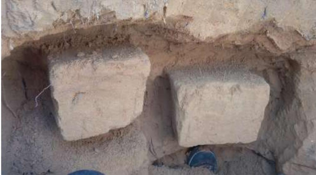
Figura 4 - Detalhe da coleta no Argissolo Amarelo Eutrocoeso Abruptico – PAex, com indicação das posições meio e base.
