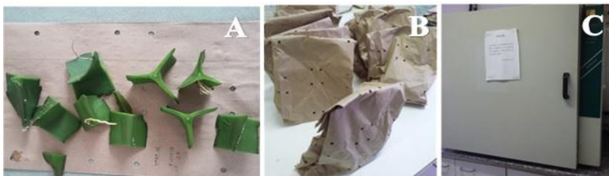
Figura 3 – Análise de crescimento, material vegetal fragmentado (A), acondicionamento em saco tipo Kraft (B) e secagem em estufa (C), Fortaleza (CE).
