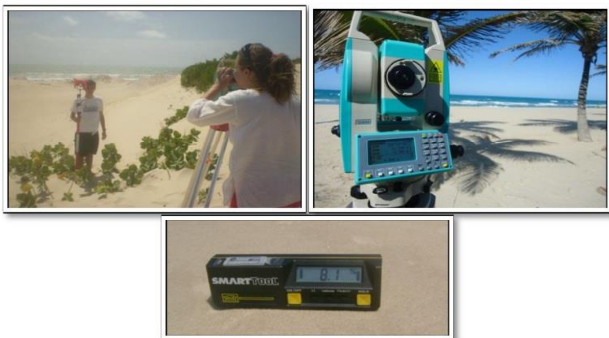
Figura 2 - Estação total e prisma utilizados para a coleta de dados de perfis e clinômetro para coleta de dados de declividade.
