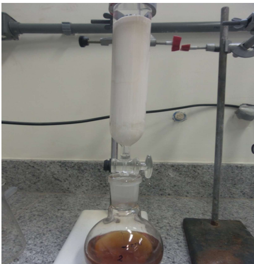
Figura 3.3 Separação cromatográfica de resinas e produtos obtidos da separação na coluna, saturados, aromáticos e resinas.
