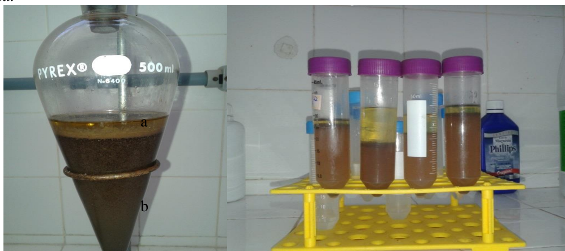
Figura 3.3.6.1.3- Decantação da mistura reacional após as reações de transesterificação in situ .
