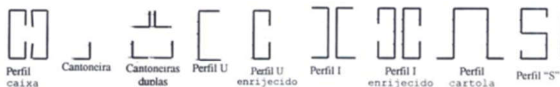
Figura 3 – Exemplos de perfis estruturais formados a frio.
