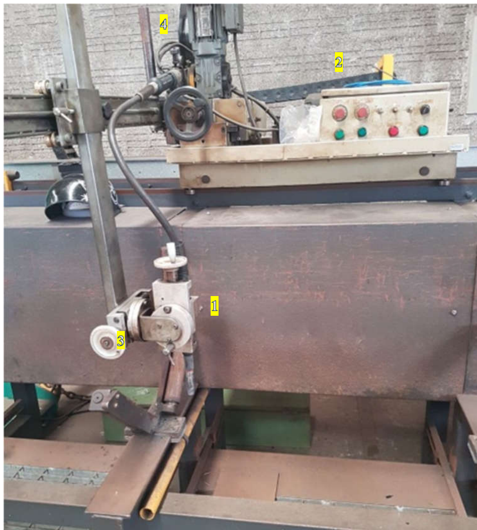
Figura 11 – Bancada automatizada utilizada na empresa. (1) tocha (2) carro tartaruga (3) suporte das peças (4) alimentador de arame.
