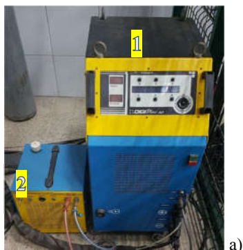
Figura 13 – a) (1) Fonte de soldagem IMC – Digiplus A7 DCDU (2) sistema de resfriamento. b) Aspecto da junta sobreposta.
