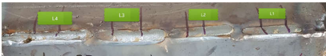
Figura 17 – Cordões de solda realizados no LPTS - UFC para Etapa II.
