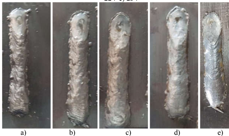
Figura 23 - Cordões de solda com velocidade de alimentação de 5,0 m/min e tensão de a) 19V b) 20V c) 21V d) 22V e) 23V
