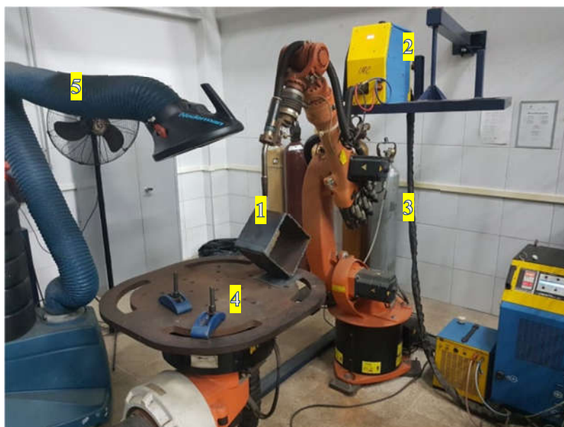
Figura 14 – Bancada Robotizada I do LPTS – UFC (1) tocha (2) alimentador de arame (3) cilindro de gás de proteção (4) corpo de prova (5) exaustor.
