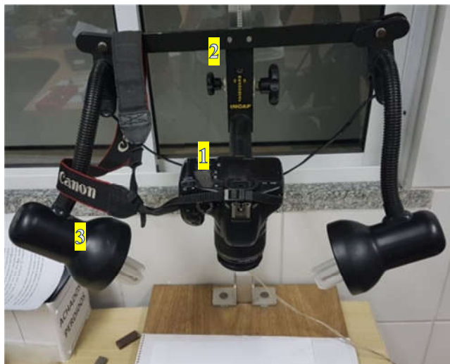
Figura 15 – Aparato para realização de macrografias (1) câmera fotográfica (2) suporte para câmera (3) iluminação.
