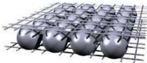
Figura 3 - Módulo de BubbleDeck
