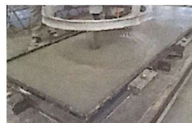
Figura 6 - Etapas de fabricação de pré-lajes com módulos BubbleDeck incorporados
