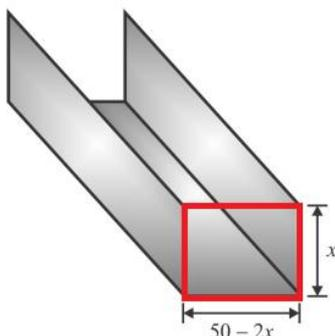
A ilustração em vermelho indica a seção transversal da calha.
