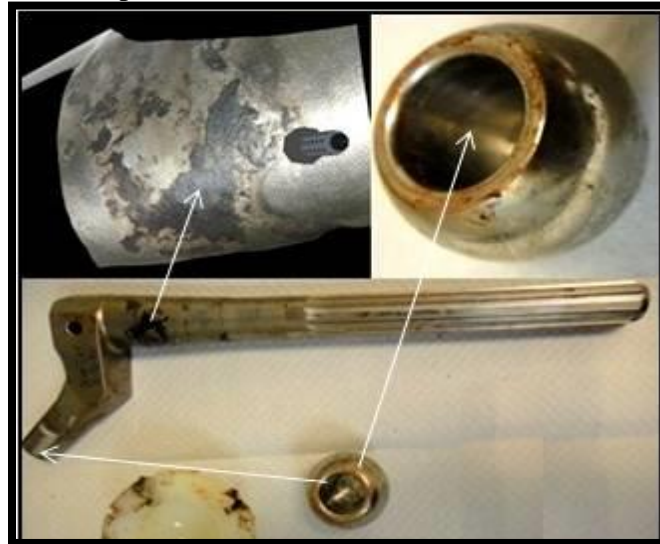
Figura 1 – Corrosão em implante de fêmur.
