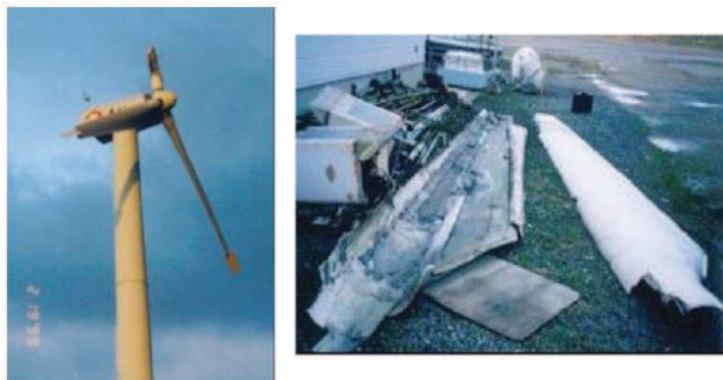
Figura 15 - Danos em pás causados por raios
