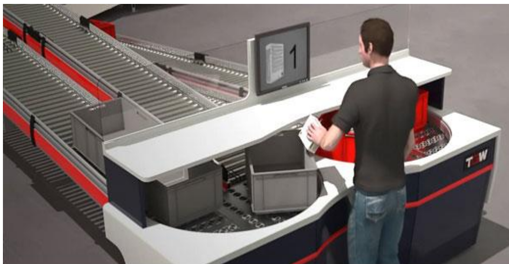
Figura 11: Sistemas automatizados de separação de pedidos
