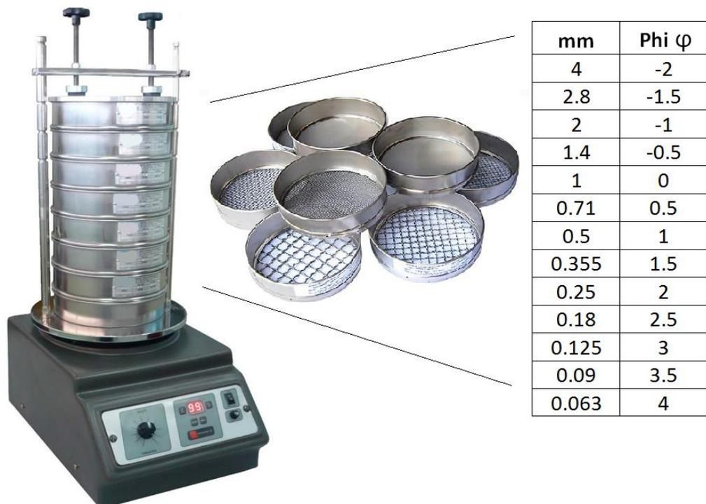
Legenda: à esquerda da figura, *rotap* com peneiras encaixadas, à direita, relação tamanho de malhas das peneiras usadas em mm e em *phi*.
