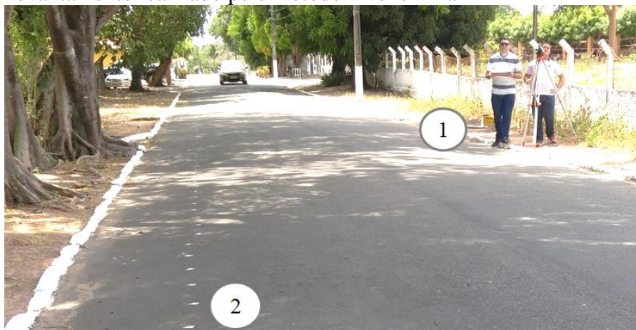
Figura 25 – Levantamento realizado pelo método nível e mira
