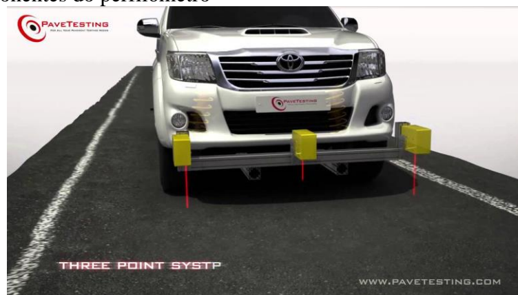
Figura 9 – Componentes do perfilômetro
