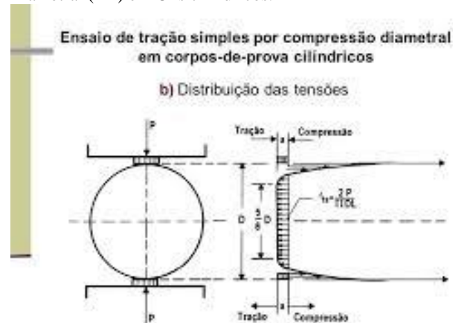
Figura 30 - Ensaio de Resistência à Tração por Compressão Diametral (RT) em CPs cilíndricos.
