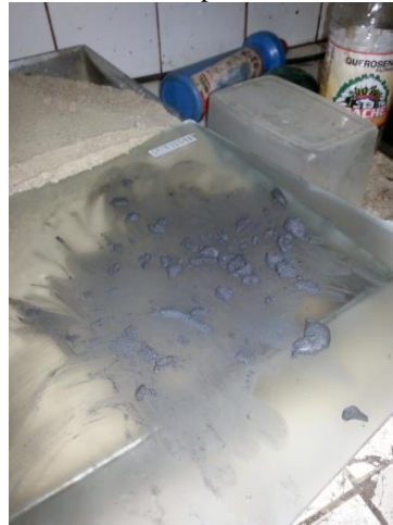
Figura 36 - Segregação da cinza volante impossibilitando a realização do ensaio do LP.
