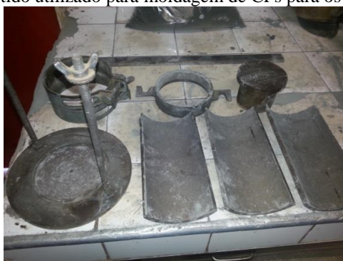
Figura 27 - Cilindro tripartido utilizado para moldagem de CPs para os ensaios de MR, RCS e RT.
