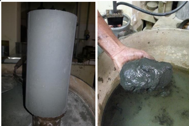
Figura 40 - CP de cinza volante antes e depois de ser imerso em água para os ensaios de RCS e RT.
