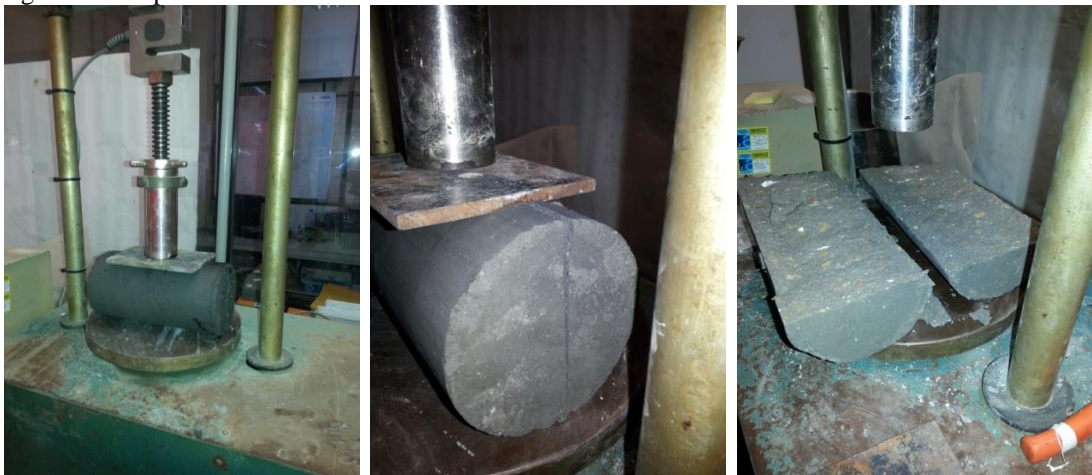
Figura 60 - Aspecto dos CPs das misturas Solo+Cinza+Cal submetidos ao ensaio de RT.
