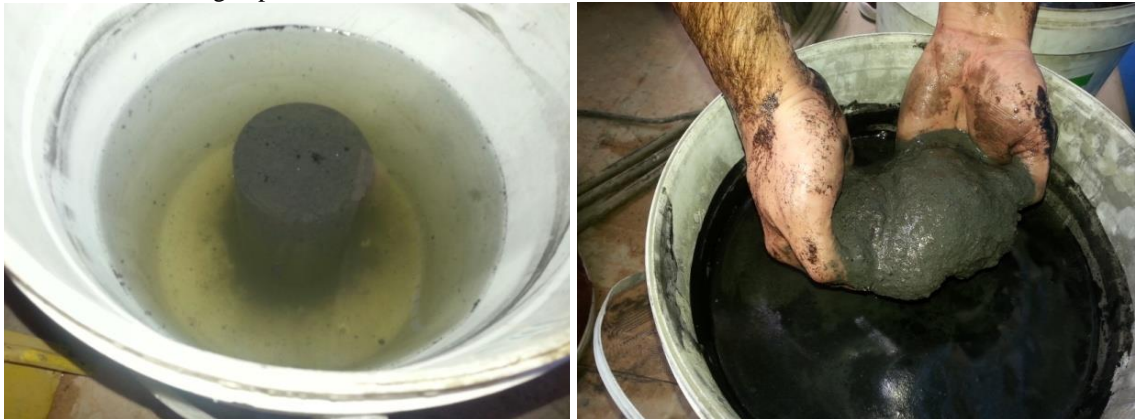
Figura 58 - Aspecto dos CPs (que não resistiram à imersão) das misturas M3Cal e M5Cal antes e depois de serem imersos em água para os ensaios de RCS e RT.
