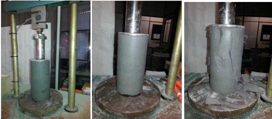
Figura 59 - Aspecto dos CPs das misturas Solo+Cinza+Cal submetidos ao ensaio de RCS.
