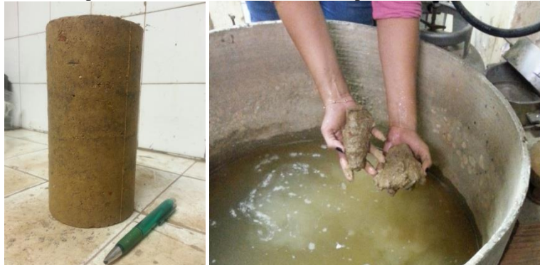
Figura 34 - Aspecto do solo de Caucaia antes e depois da imersão de 24 horas.
