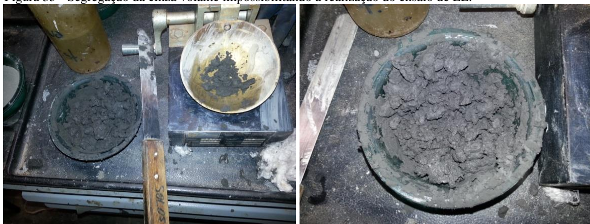
Figura 35 - Segregação da cinza volante impossibilitando a realização do ensaio de LL.
