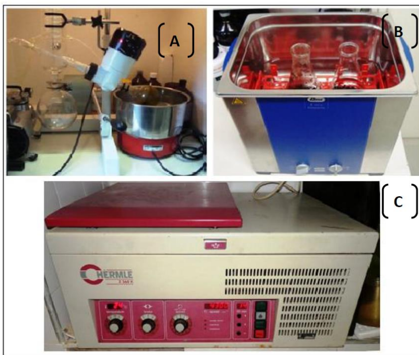
Figura 10 Equipamentos usados no procedimento de extração: rotaevaporador (A), banho ultrassom (B), centrífuga (C).
