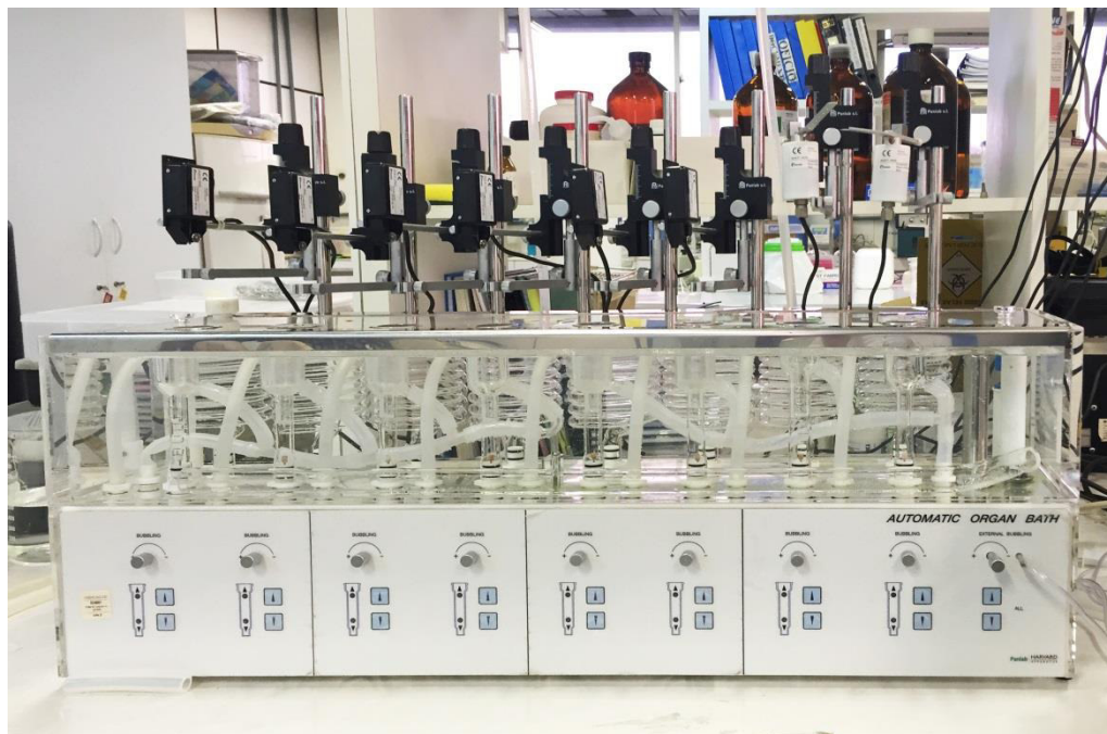
Figura 7. Sistema para aquisição de dados in vitro (banho de órgãos).
