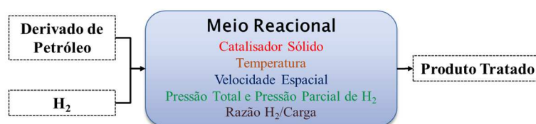
Figura 1 – Representação de um processo de HDT e suas variáveis operacionais.
