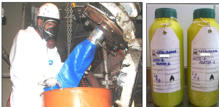
Figura 45 – Coleta dos catalisadores em 2014 e frascos de armazenamento.
