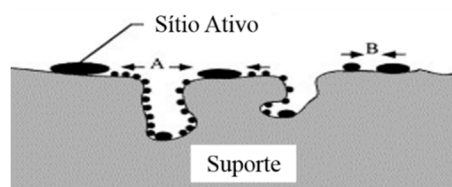
Figura 43 – Modelo de crescimento do cristalito devido sinterização (A) e migração atômica (B) (adaptado de Barthlomew, 2001).
