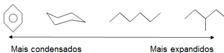
Figura 4 – Transformações na estrutura molecular através do HDR.
