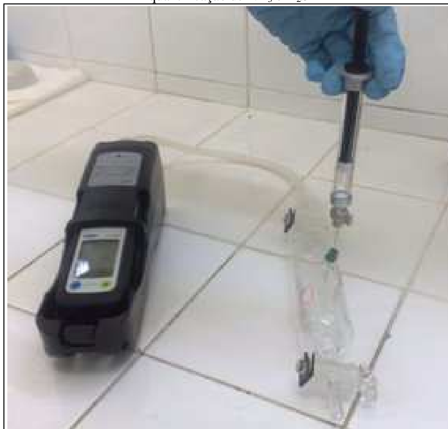
Figura 12 – Procedimento de diluição do biogás em bulbo de vidro para quantificação de \text{NH}_3 e \text{H}_2\text{S}
