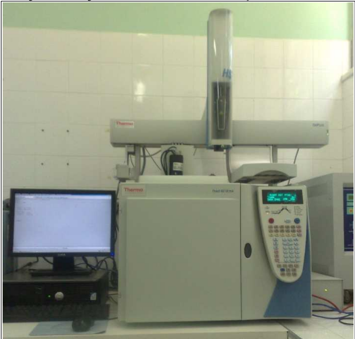
Figura 3 - Cromatógrafo HS-GC-PID-FID utilizado na determinação dos BTEX estudados.
