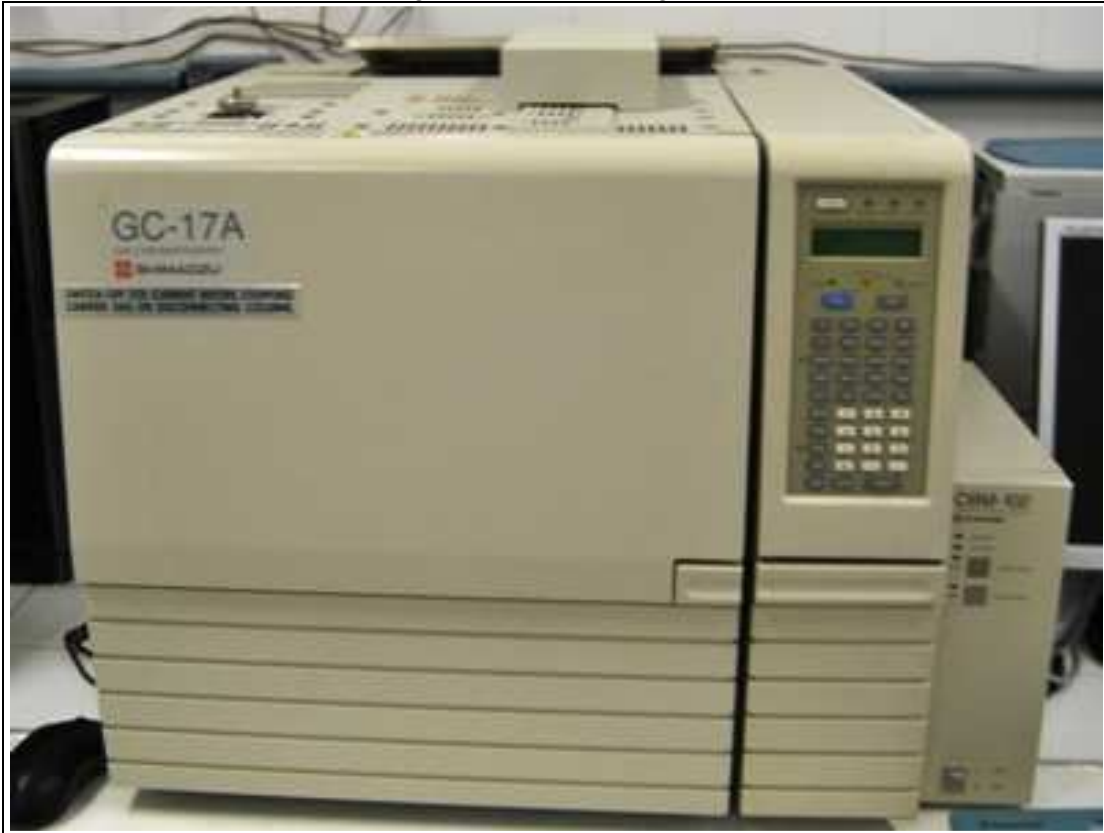
Figura 6 – Cromatógrafo GC-TCD utilizado para a determinação e quantificação do metano e gás carbônico no biogás
