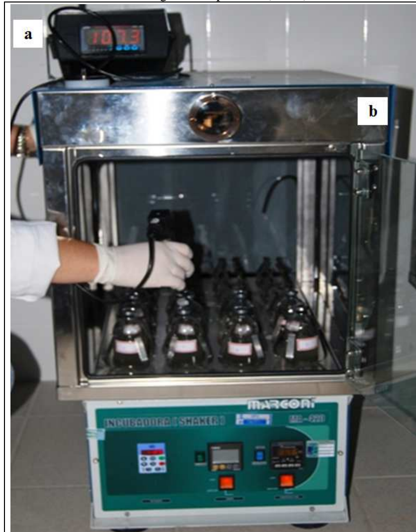
Figura 5 – Equipamento utilizado na realização do teste de Atividade Metanogênica Específica (AME).
