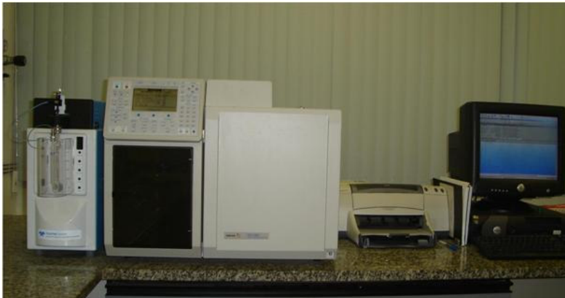
Figura 4. Cromatógrafo a gás modelo VARIAN CP-3380 acoplado a um microcomputador
