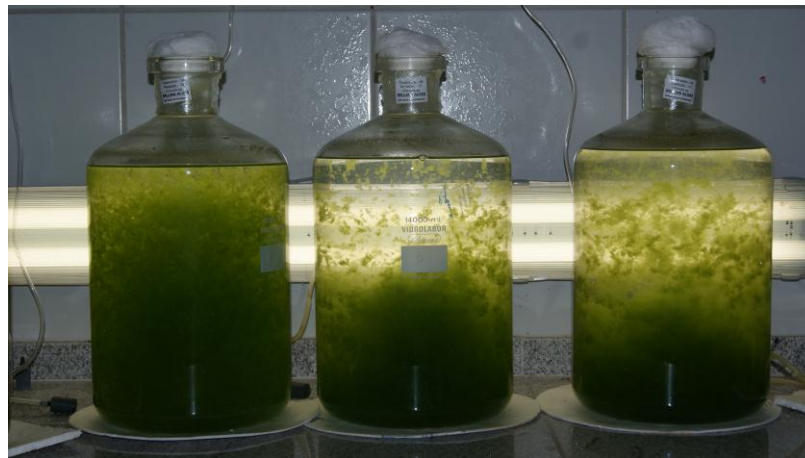
Figura 3 - Processo de floculação química de C. vulgaris pela adição de NaOH 2 N no meio de cultivo.
