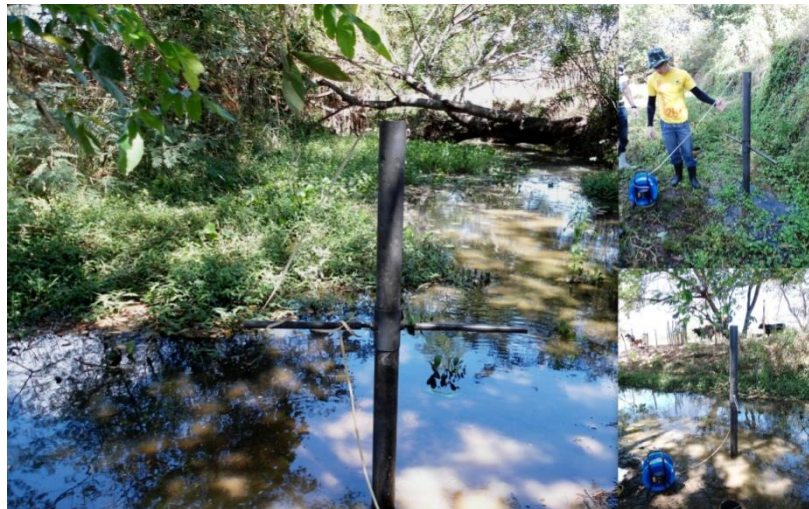
Figura 14 - Medição da carga hidráulica no tubo cravado no sedimento da aluvião.
