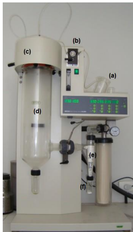
Figura 2 – Fotografia do equipamento Spray dryer B-290 (BÜCHI) e seus principais componentes
