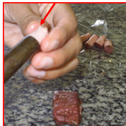
6b. Obtenção das amostras cilíndricas
