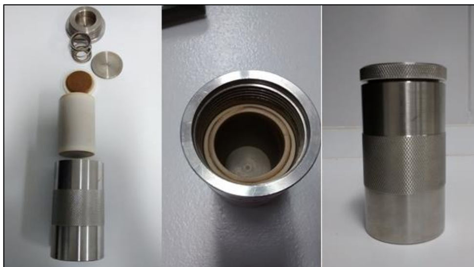
Figura 7 – Reator de teflon e autoclave de aço inox utilizado nas sínteses
