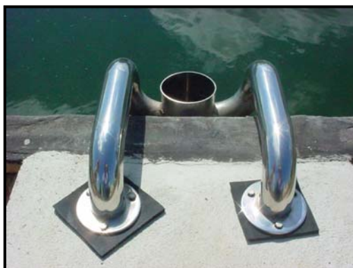
FIGURA 8 – Poço tranqüilizador em aço inox, adaptado para os tanques de 20m 2 .
