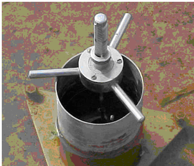
FIGURA 6 – Poço tranquilizador de base triangular com parafusos de nivelamento nos vértices e micrômetro de gancho.
