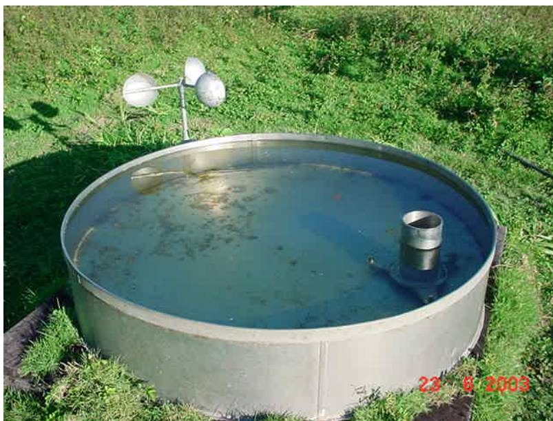
FIGURA 5 - Tanque evaporimétrico "Classe A" instalado com poço tranquilizador e anemômetro.
