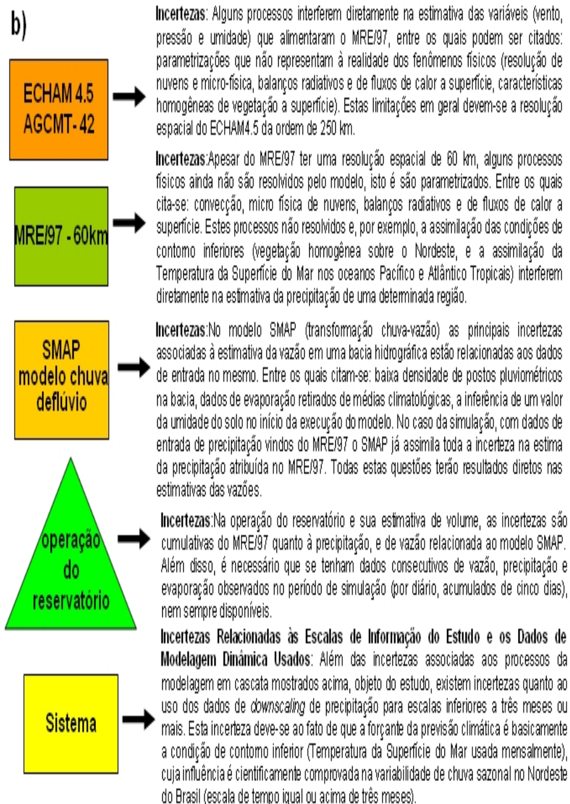
FIGURA 20 - a) Esquema representativo do acoplamento entre a modelagem dinâmica da atmosfera e a modelagem hidrológica com aplicação final na operação de um reservatório hídrico. b) Incertezas associadas em cada processo da modelagem dinâmica em cascata.
