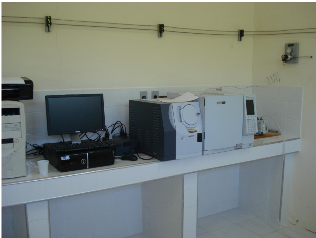
FIGURA – 5: Cromatógrafo em fase gasosa acoplado por Espectrômetro de massas utilizado para a determinação dos BTEX.
