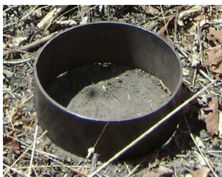
Figura 5 – Cilindro de aço usado para delimitar a parcela circular na amostragem do banco de sementes no solo.
