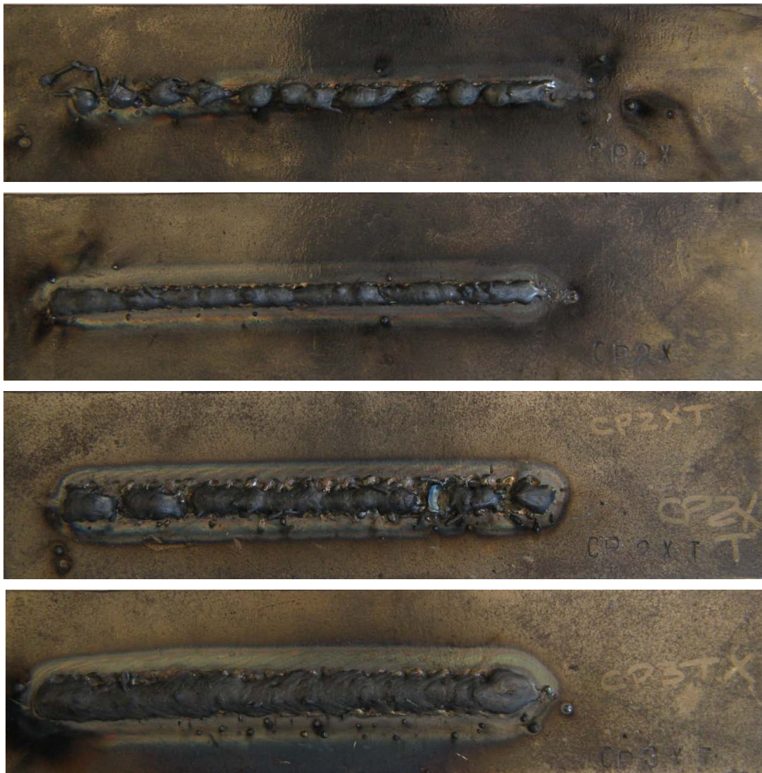
Figura 68. Amostras soldadas utilizando corrente pulsada.
