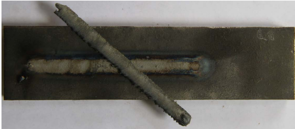
Figura 69. Fotografia do ensaio no qual o cordão de solda não aderiu ao metal base.
