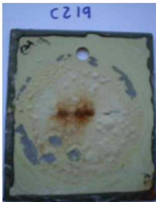
Figura 32 – Fotografia da amostra CZ19 pintada com tinta pigmentada com cromato de zinco após 40 dias de imersão.
