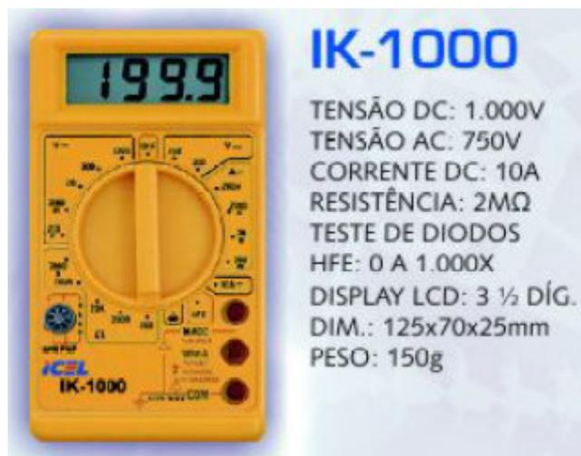
Figura 21 – Fotografia e dados de catálogo do voltímetro utilizado.
