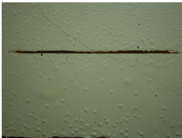
Figura 42 – Fotografia da área no entorno do risco da amostra M12 após exposição de 1550h em câmara de névoa salina.
