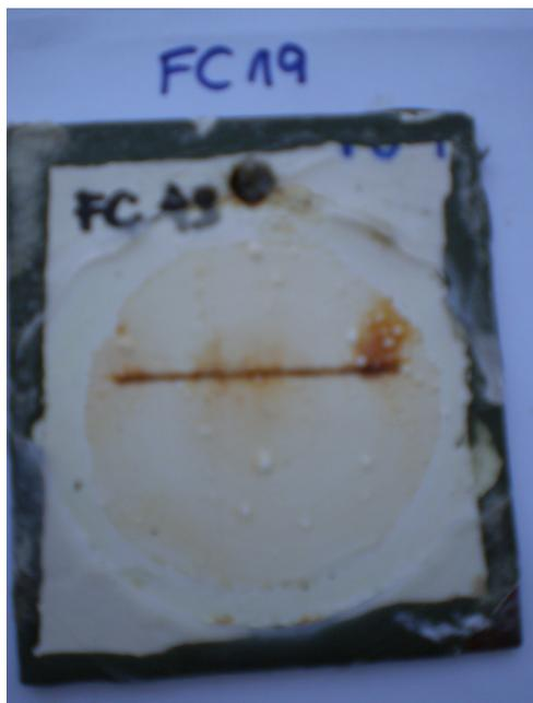
Figura 36 – Fotografia da amostra FC19 pintada com tinta pigmentada com sílica trocadora de cálcio e fosfato de zinco após 40 dias de imersão.
