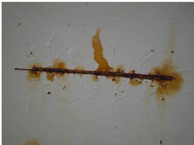
Figura 44 – Fotografia da área no entorno do risco da amostra FC7 após exposição de 1550h em câmara de névoa salina.
