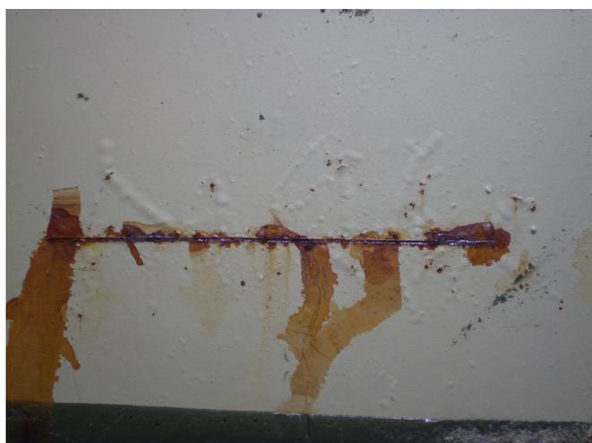
Figura 40 – Fotografia da área no entorno do risco da amostra CZ6 após exposição de 1550 h em câmara de névoa salina.
