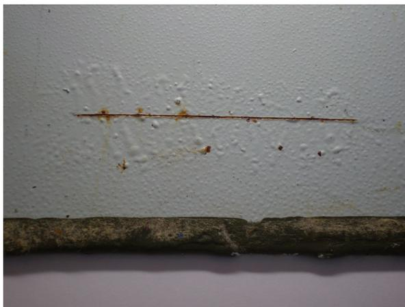
Figura 41 – Fotografia da área no entorno do risco da amostra FZ2 após exposição de 1550h em câmara de névoa salina. Pequenos pontos de corrosão na região do risco podem ser atribuídos ao corte do empolamento.
