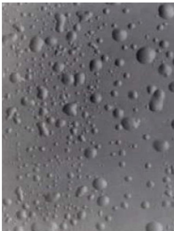
Figura 13 – Padrão fotográfico classificado como tamanho da bolha número 2 e frequência MD (*médium dense*) de acordo com a Norma ASTM D 714 (fora de escala).
