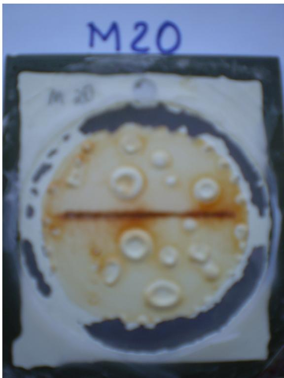
Figura 34 – Fotografia da amostra M20 pintada com tinta pigmentada com fosfato molibdato de zinco e cálcio.
