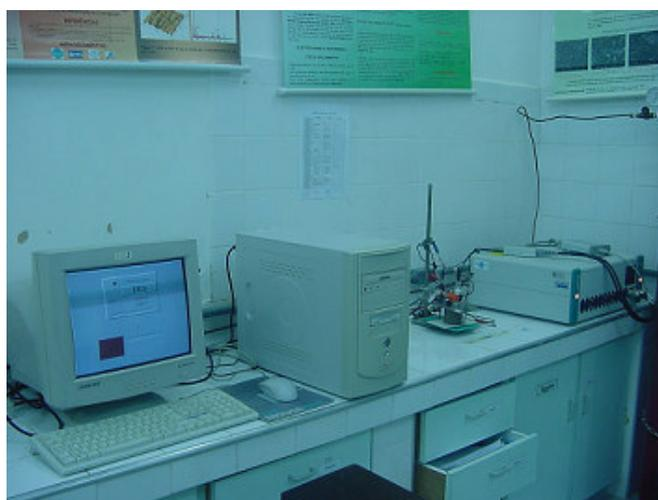
Figura 23 – Fotografia do sistema eletroquímico de medição por EIE.
