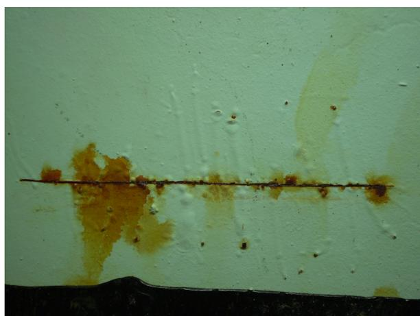
Figura 43 – Fotografia da área no entorno do risco da amostra CS8 após exposição de 1550h em câmara de névoa salina.
