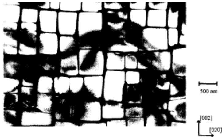
Figura 2.1 – Análise em microscópio de transmissão mostrando a morfologia da fase \gamma' em uma liga monocristalina CMSX-4, desenvolvida pela Associação Industrial de Pesquisa Científica de Moscou (Wanderka, 1995).
