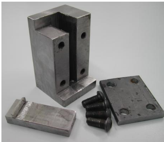
Figura 3.8 – Foto do dispositivo fabricado para ensaio de arrancamento e de um corpo de prova ensaiado.
