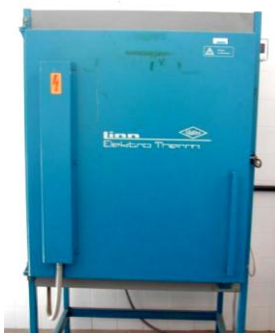
Figura 3.2 – Forno utilizado para tratamento térmico de envelhecimento.
