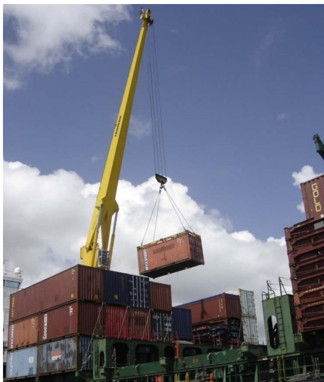
Figura 3.10 – Operação de descarga com guindaste de bordo no Porto de Fortaleza em 2006
