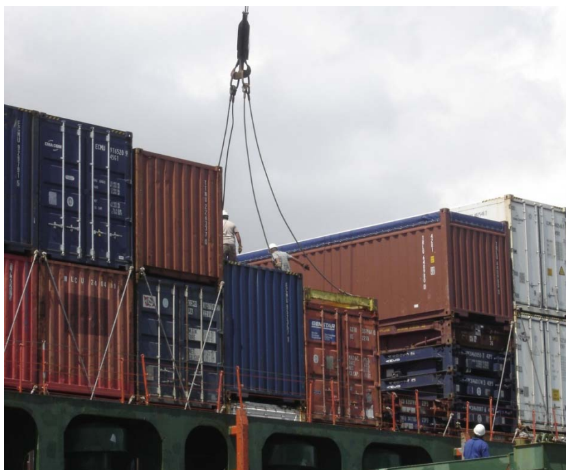
Figura 3.9 – Amarração do contêiner a bordo do navio no Porto de Fortaleza em 2006
