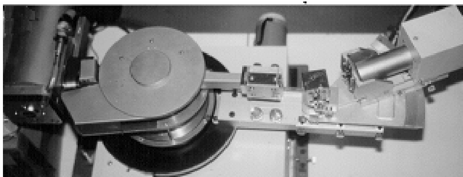
Figura 6.3 Geometria Bragg-Brentano do difratômetro.
