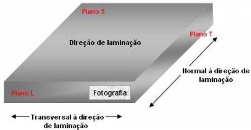
Figura 4.8. Desenho esquemático das seções a serem analisadas pelo ferritoscópio.
