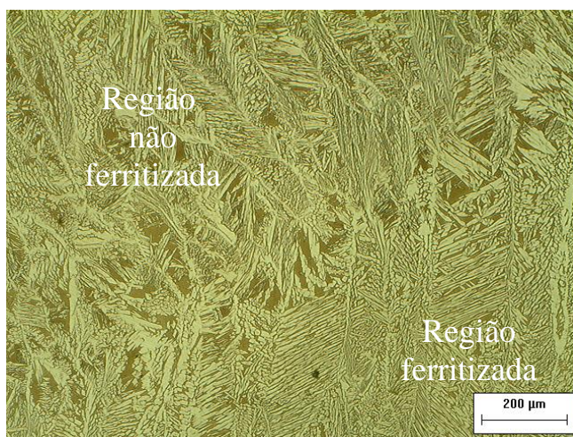
Figura 6.19. Efeito dos passes laterais para a condição C4.
