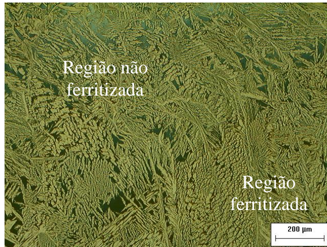
Figura 6.10. Efeito dos passes laterais no 1º cordão de solda.
