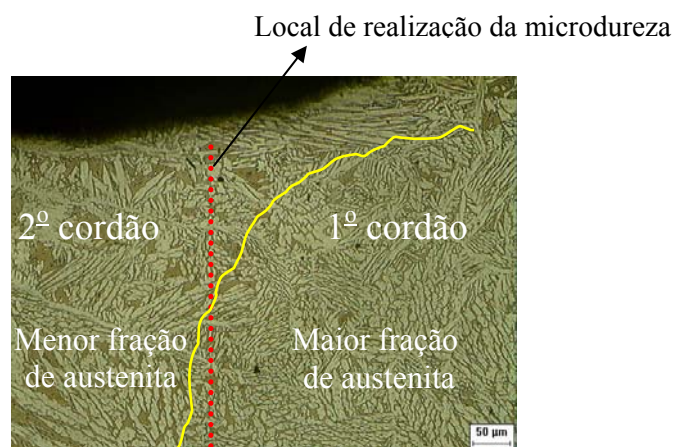
Figura 5.34. Microestrutura mostrando a interseção entre dois cordões subsequentes (linha amarela). Aumento de 100X.
