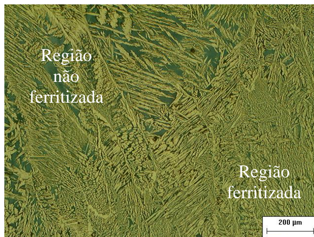
Figura 6.15. Efeito dos passes laterais no 1 o cordão de solda.
