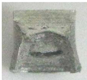
Figura 7.73. Aspecto da fratura do metal base.
