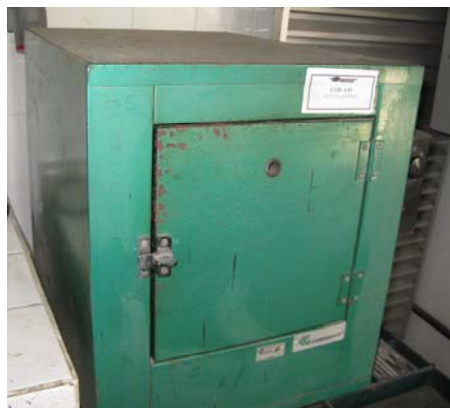
Figura 4.5. Estufa para a secagem dos eletrodos revestidos.
