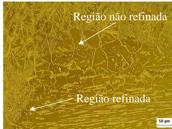
Figura 7.24. Região de intersecção entre duas camadas subseqüentes.
