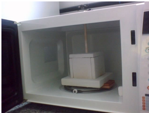
Figura 3. 3 - Célula susceptora no interior do forno microondas
