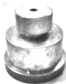
Figura 3. 4 - Molde empregado na prensagem dos corpos verdes
