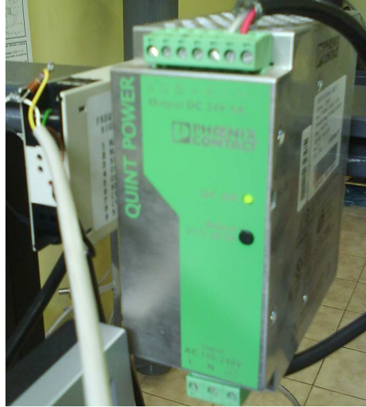
Figura B.12 - Rotômetros de água (esquerda) e Fonte do sistema de aquisição (direita).
