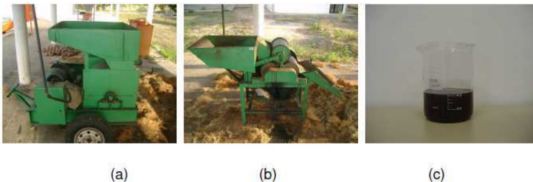
Figura A.5 - (a) Triturador; (b) Máquina de prensagem; (c) Amostra do LCCV.
