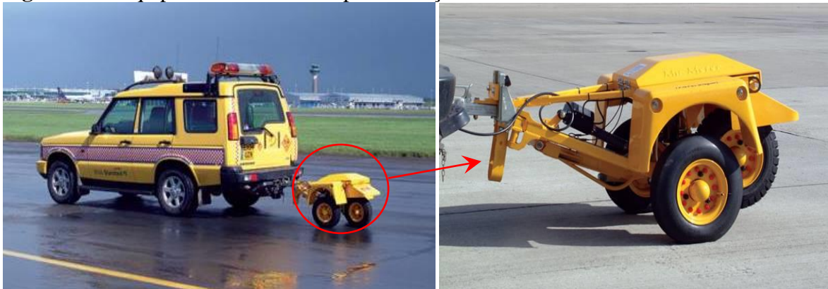
Figura 18 – Equipamento Mu-Meter para medição de atrito.
