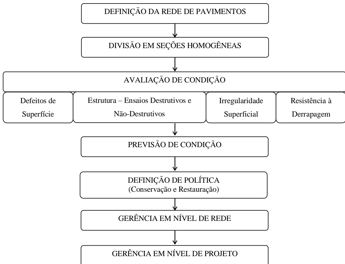
Figura 4 – Fluxo de um Sistema de Gerenciamento de Pavimentos Aeroportuários.
