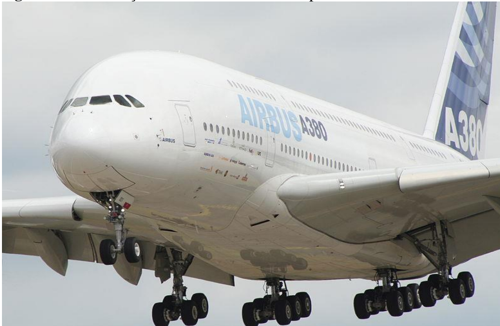
Figura 6 – Distribuição das rodas e dos trens de pouso do Airbus A380.
