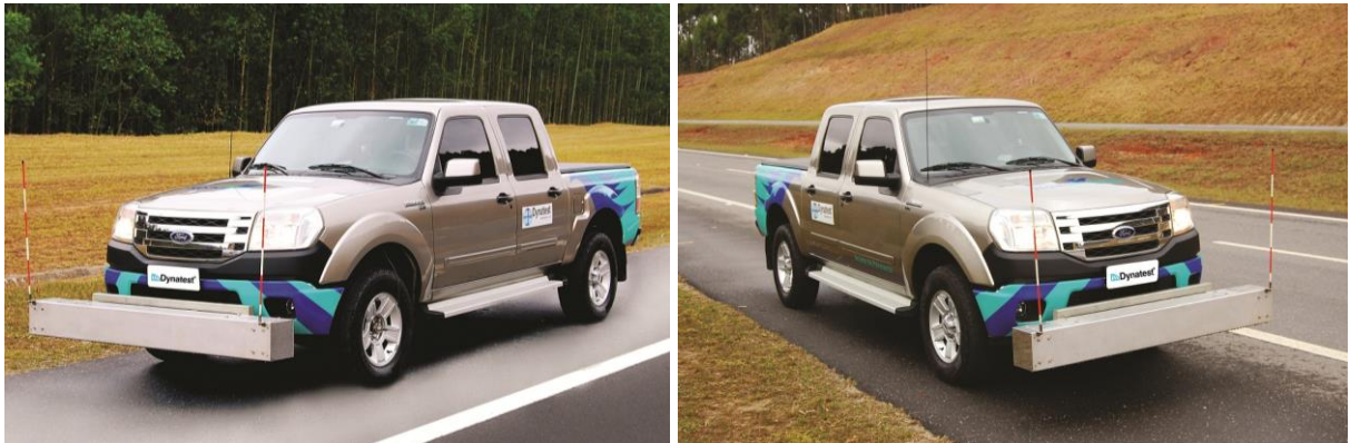
Figura 13 – Exemplos de perfilômetros a laser.
