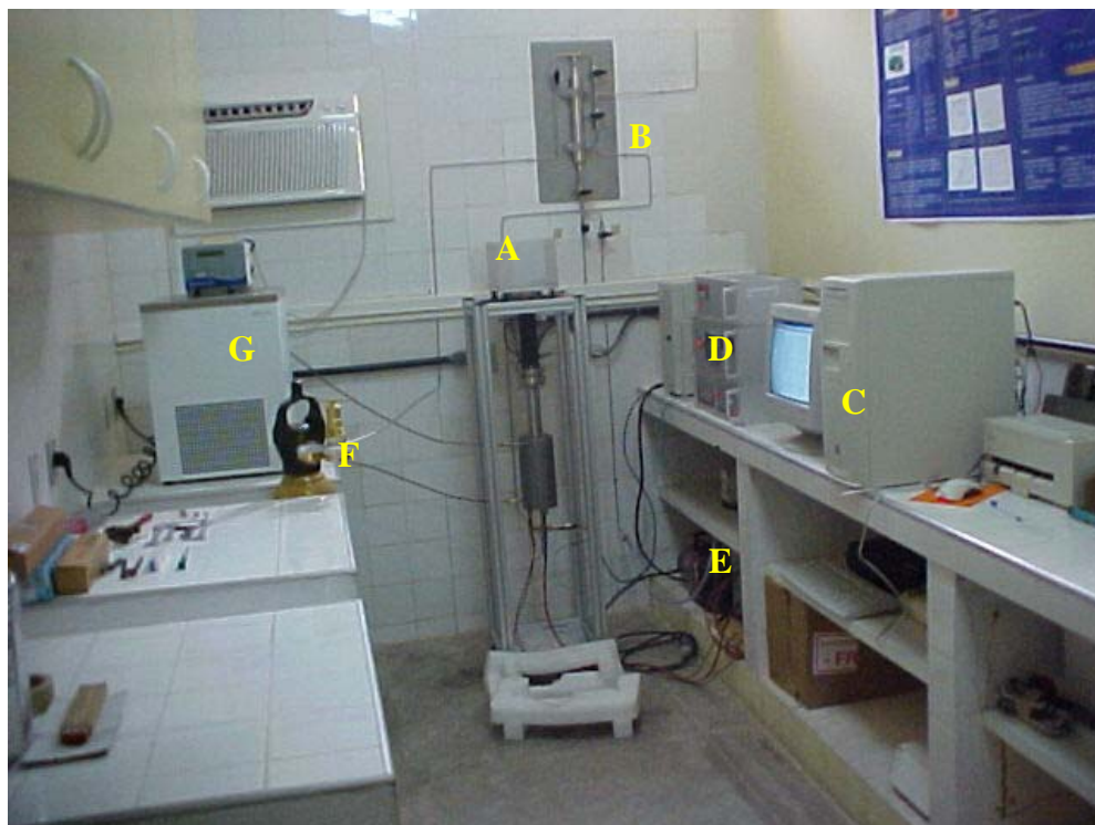
Figura III. 3 – Sistema para estudos gravimétricos de equilíbrio de adsorção, composto de balança termogravimétrica (A), linha de gases (B), computador (C), interface de aquisição de dados (D), bomba de vácuo (E), cilindro de metano (F) e banho termostático (G).
