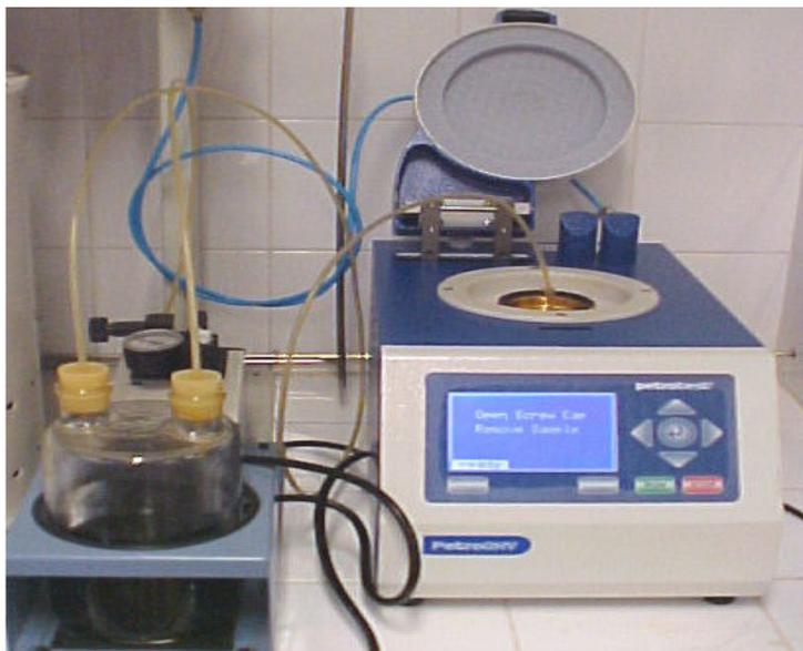
**Figura 3.2:** Equipamento utilizado nos ensaios de estabilidade oxidativa (Método-ASTM D 7545, 2009).
