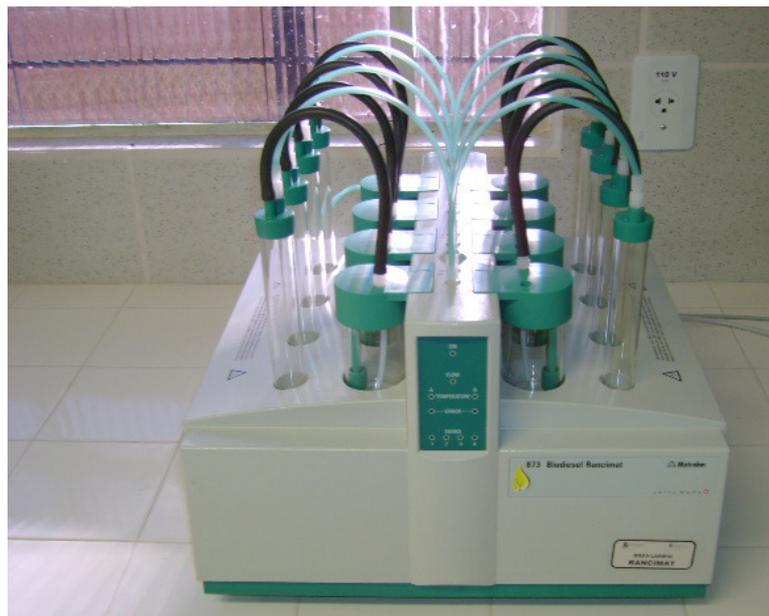
**Figura 3.4:** Equipamento utilizado nos ensaios de estabilidade oxidativa (Método- EN14112, 2003).
