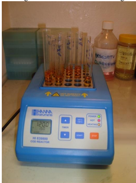
Figura 12 – Digestão da amostra em bloco digestor
