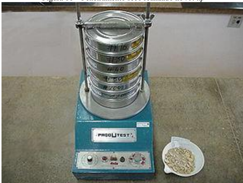
Figura 10 – Peneiramento seco realizado no rot up
