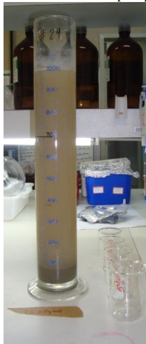
Figura 9 – Proveta com material fino para pipetagem
